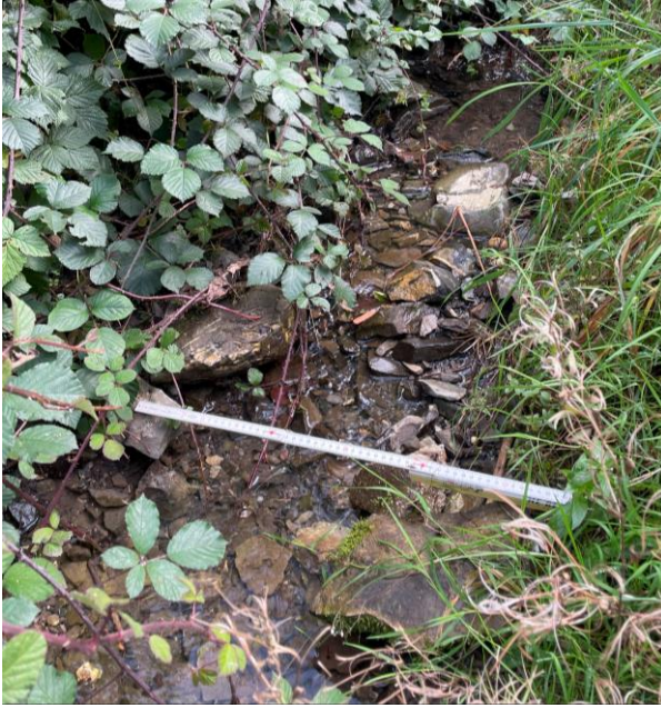
Abb. 8: Erhebung aktueller Sohlenbreite (Foto R+K, 04.10.2023)
